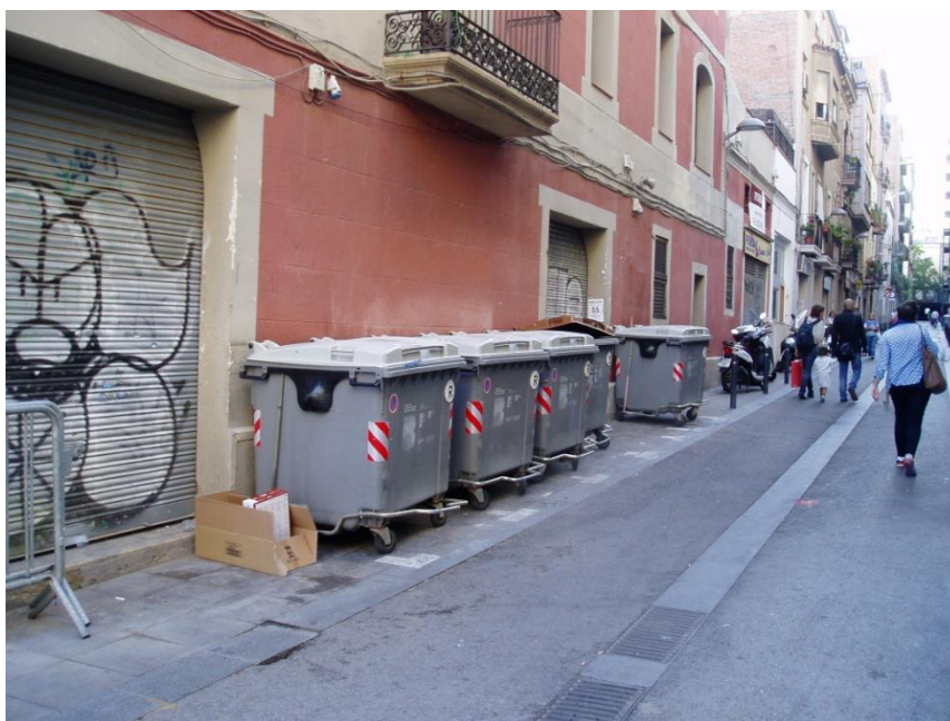
Imatge: un grup de contenidors del carrer Berga de Barcelona, envaeixen l'espai de l'ample lliure de pas de l'itinerari de vianants.
